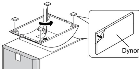
2 Justera högtalarens vinkel på foten som önskas, och drag därefter fast skruven.
