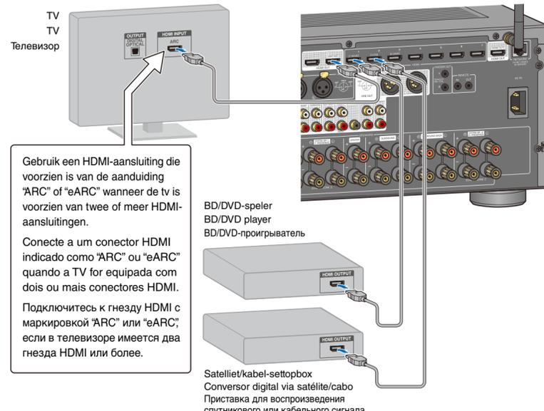
Gebruik een HDMI-aansluiting die voorzien is van de aanduiding "ARC" of "eARC" wanneer de tv is voorzien van twee of meer HDMI-aansluitingen.
