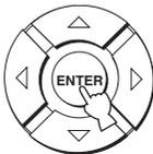
**4** Drücken Sie  $\triangleleft / \triangleright$ , um zwischen „PROTECT: ON“ und „PROTECT: OFF“ umzuschalten.
