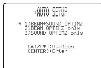
**5 Нажимая  $\triangle$  /  $\nabla$ , выберите BEAM+SOUND OPTIMZ, BEAM OPTIMZ only или SOUND OPTIMZ only и затем нажмите ENTER.**
